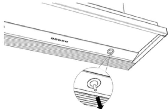
Une ventouse est fournie avec la hotte pour faciliter le retrait des lampes. Placez la ventouse sur la lampe halogène et tirez celle-ci vers vous. La lampe se dégage de son support. Vous pouvez également installer la nouvelle lampe à l'aide de la ventouse.
